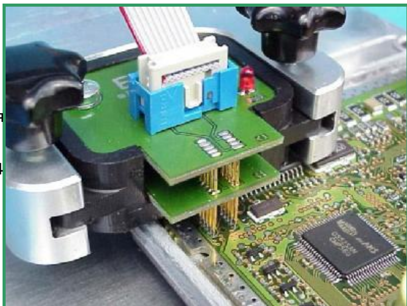
Рис. D: Площадка BDM в блоках управления Marelli
