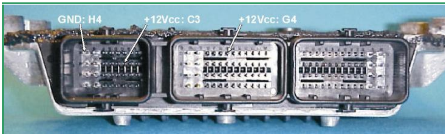
Рис.А: Распиновка по питанию для блоков Siemens SID206 ECU аналогично блоку Siemens SID803
