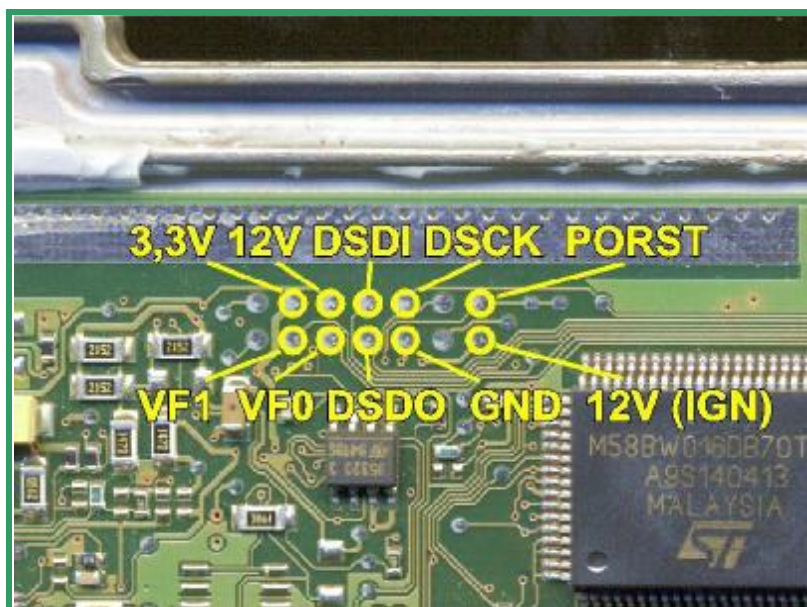
Рис. В: Распиновка контактов для программирования BOSCH.
