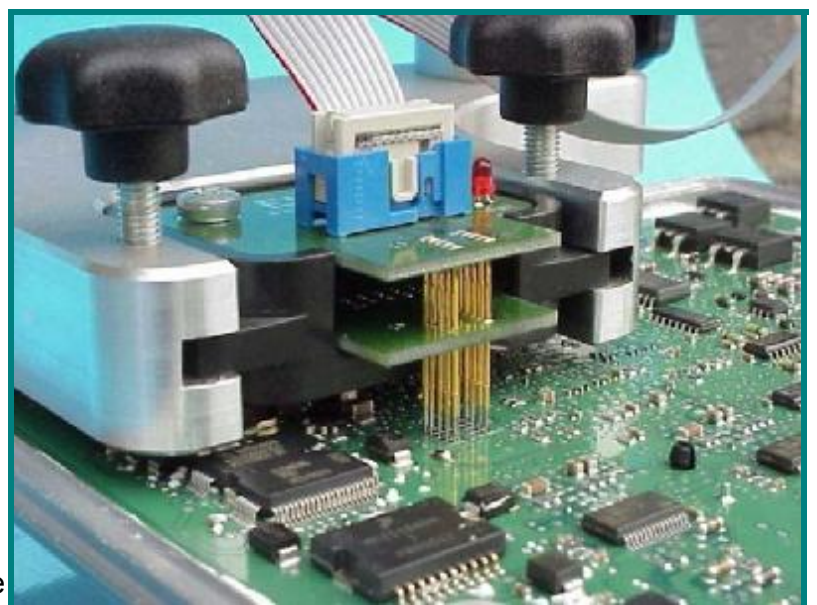
Рис.С: BDM141 в работе.
