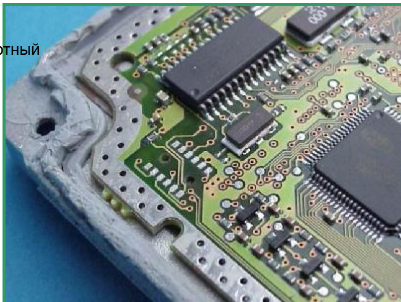
Рис. D: Площадка BDM в блоках управления Marelli
