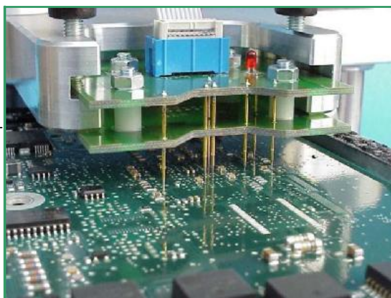
Рис С: Для лучшего контакта, опускайте контакты так, чтобы их подпружиненная часть сжалась не менее 2 мм
