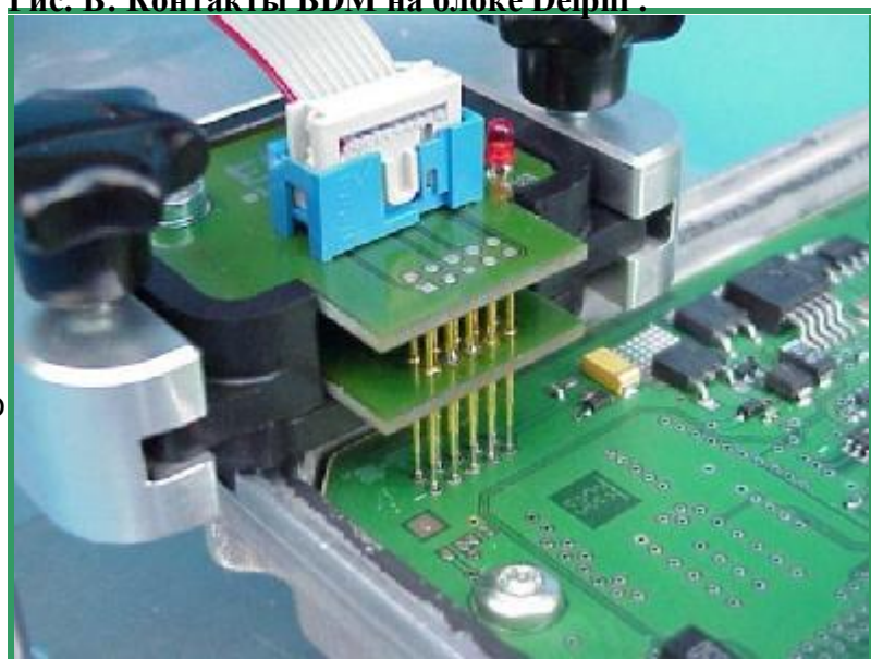
Рис. В: Контакты BDM на блоке Delphi .
