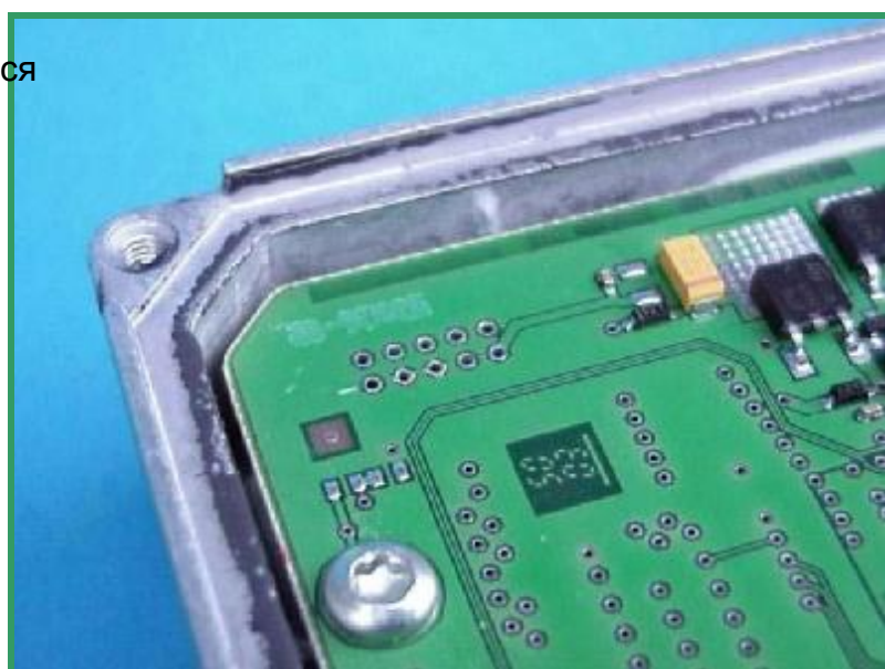
Рис. В: Контакты BDM на блоке Delphi .
